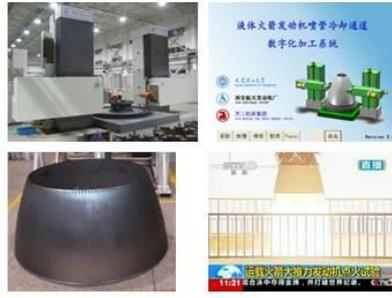
液体火箭发动机喷管数字化加工技术与装备
