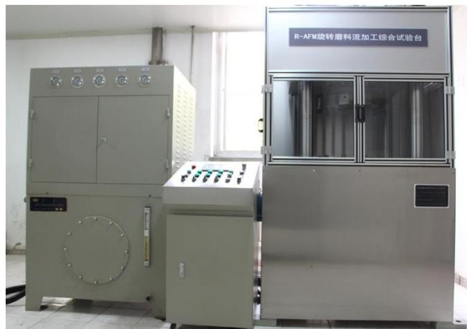
图 磨粒流加工设备
