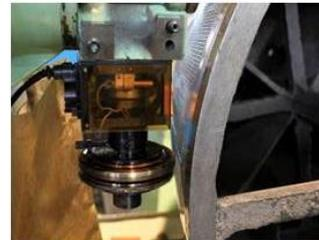
复杂曲面零件在机测量
