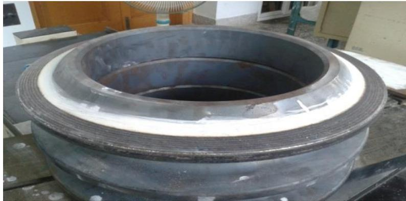
图 激光合金化（盾构机滚刀）
