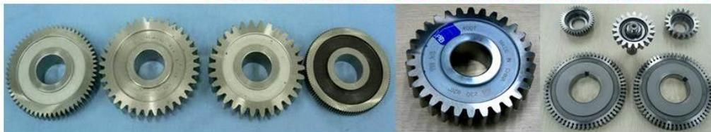
1级精度标准齿轮已经提供给中国计量科学研究院和中国计量测试研究院, 作为国家齿轮量值传递的实体基准。
