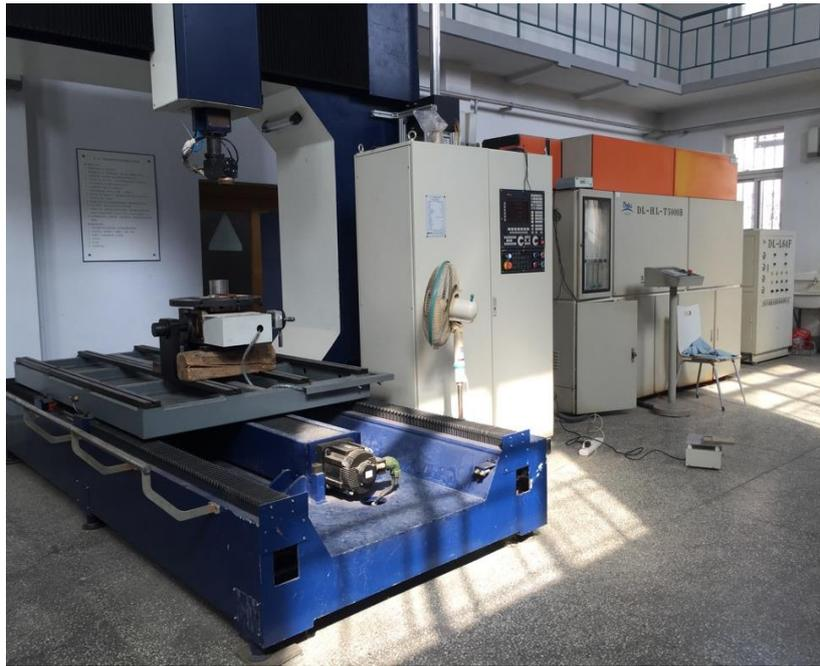
图 5kW  $\text{CO}_2$  激光加工系统
